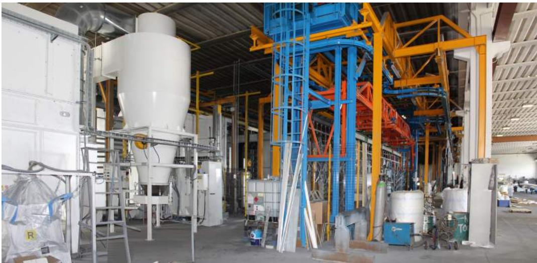
Così importante che abbiamo recentemente effettuato una modifica sostanziale della linea di verniciatura, per integrare un forno IR intermedio tra le due cabine di verniciatura a polveri (fig. 11). In questo modo abbiamo reso ancora più flessibile ed efficiente l'impianto, che ci permette di applicare cicli complessi in metà tempo».
