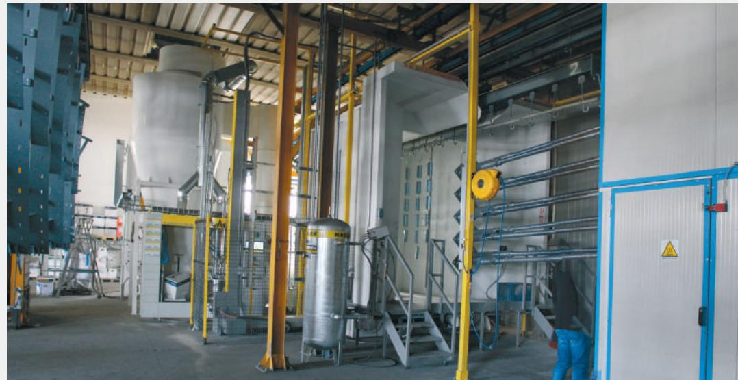
**6 – La cabina d'applicazione dei fondi in polvere. Sulla destra, la struttura del nuovo forno intermedio IR catalitico a gas (Infragas Nova Impianti).**
