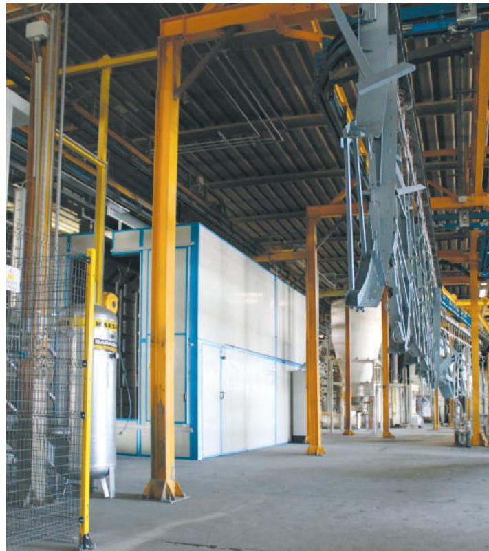
**11 – Il forno IR (Infragas Nova Impianti) è stato installato tra 2 cabine a polveri, in modo da poter effettuare cicli bistrato utilizzando l'impianto in modo altamente efficiente.**
