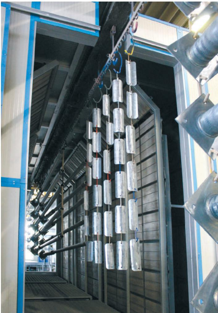
**13 – Il forno intermedio IR ha dimensioni utili importanti (7.700 x 1.500 x 3.000 h). La gestione delle potenze è divisa in 4 zone (1 orizzontale 3 verticali), per consentire l'uso ottimale dell'energia erogata ed evitare la sovraccottura dei pezzi più leggeri.**
